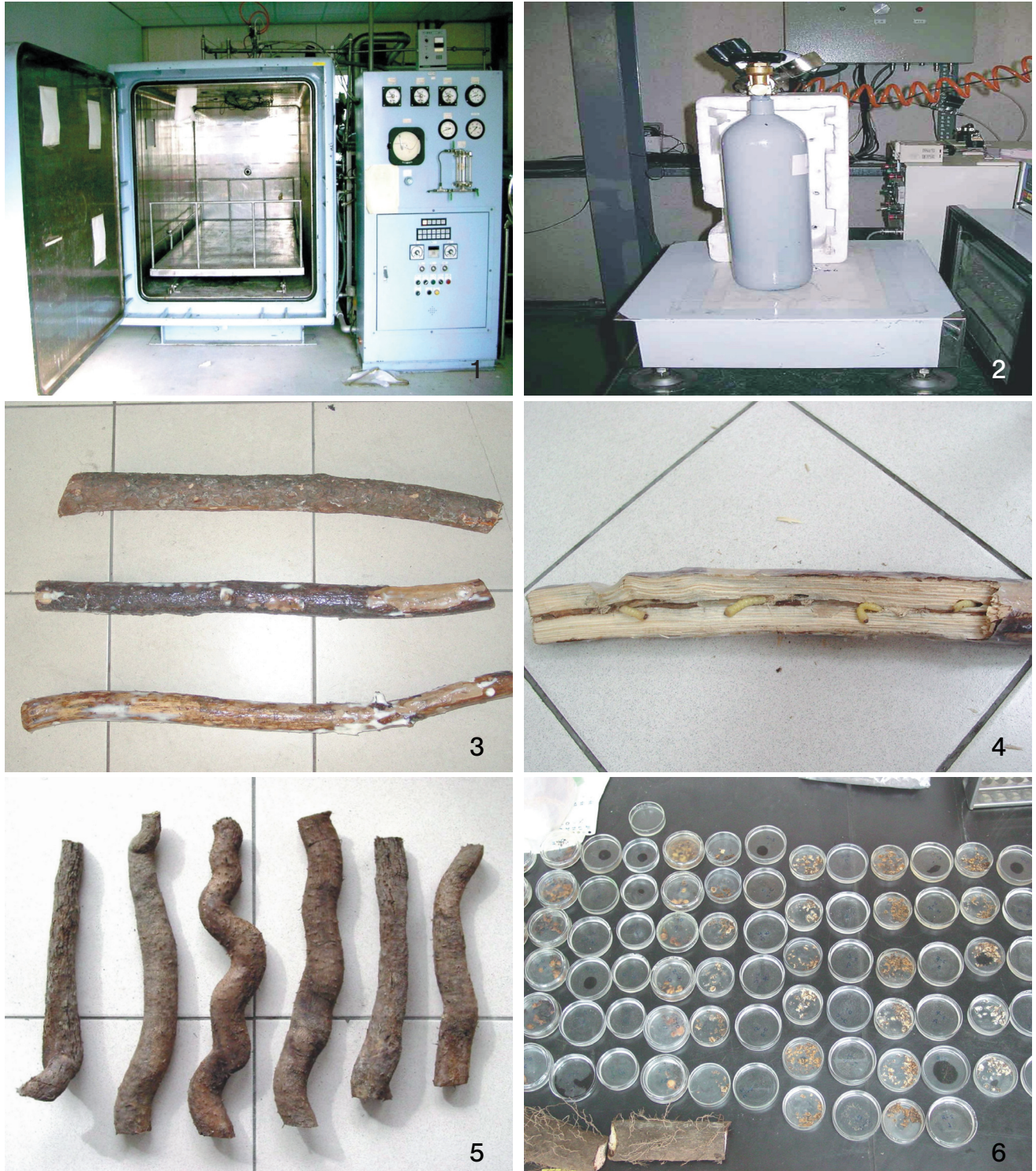
圖一：本次試驗所使用之低溫減壓燻蒸消毒器 (特許理興業株式會社, 日本製造)
